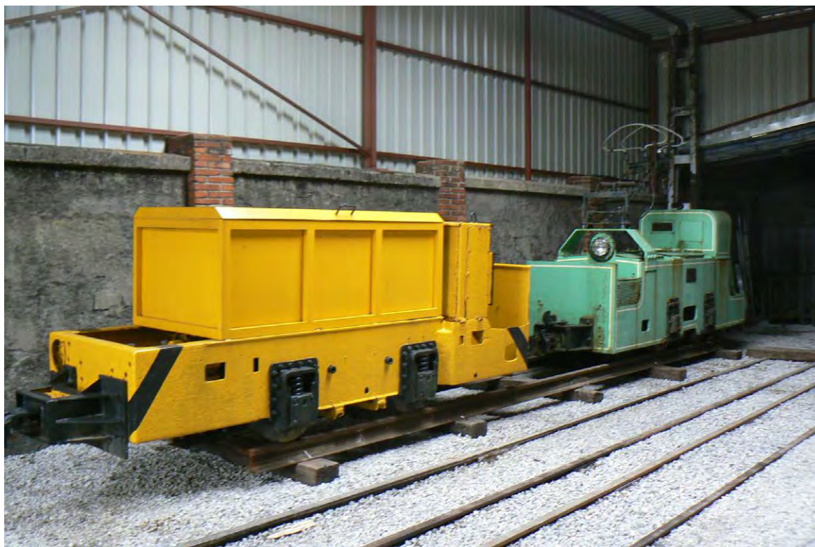
Figura 8. Locomotora minera eléctrica "Juan Sitges" (a la derecha) y locomotora minera eléctrica a baterías para trabajos en galerías (a la izquierda).
